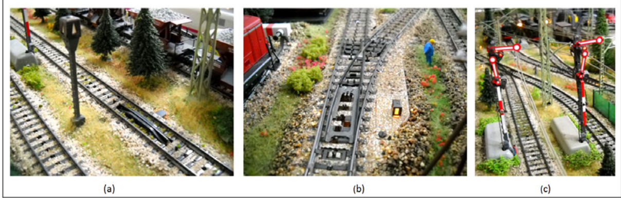
Şekil.2 (a) Vagon ayırıcı, (b) Makas, (c) Çift kollu sinyal
