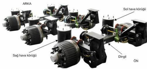
Şekil 3. Treylelerde kullanılan standart hava körüklü 3'lü dingil seti.
