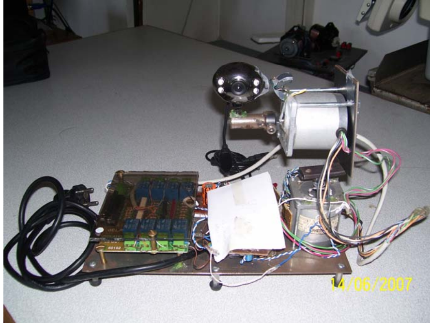
Resim 6.2 X ve Y Eksenli WebCam Cihazı (Paralel Port Kontrollü) Görüntüsü
