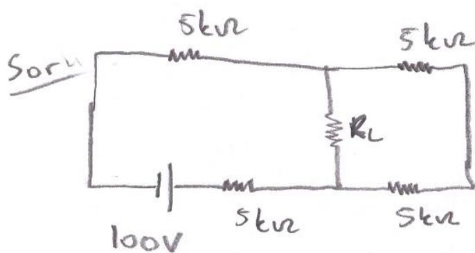
$R_L = 5\text{k}\Omega, 10\text{k}\Omega, 20\text{k}\Omega$
