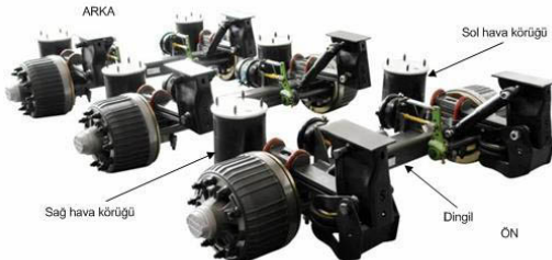
Şekil 3. Treylelerde kullanılan standart hava körlüklü 3'lü dingil seti.
